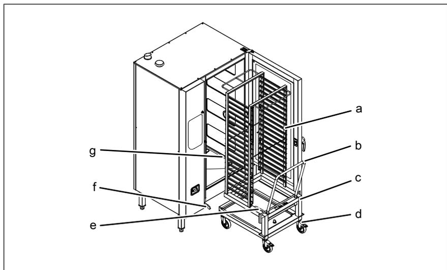
Bild: Beschicken und entleeren mit Hordenwagen
