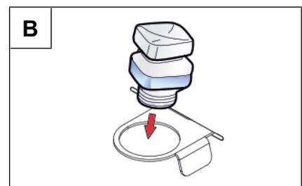
Bild: A: Kartusche in Federhalter einsetzen; B: Kartusche in Halter einsetzen
